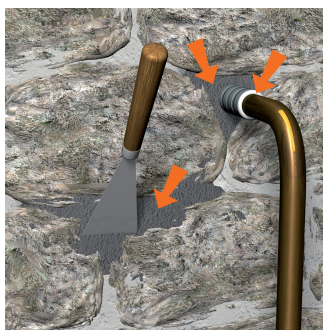
Situation après travaux : colmatage des voies d'eau.
